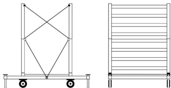
**ШАГ 6.** Соединить рамки маршевые диагональными связями\* при помощи флагковых фиксаторов.
