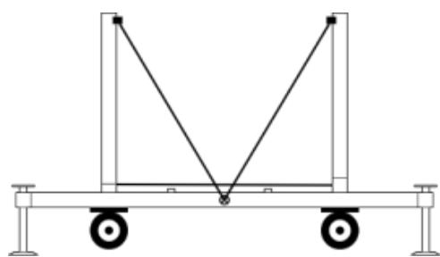
**ШАГ 4.** Соединить рамки маршевые и основание диагональными связями\* при помощи флагковых фиксаторов.
