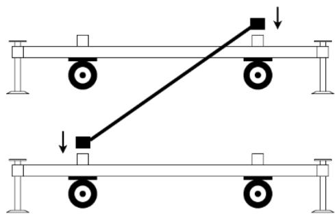
**ШАГ 1.** Установить колеса на «Опоры с домкратами» с помощью болтового соединения. Размещаем «Опоры с домкратами» параллельно друг другу.
