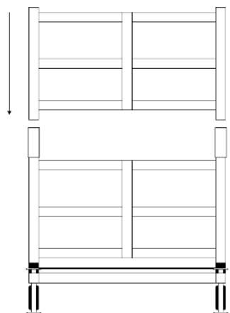
**ШАГ 6.** Установить второй уровень маршевых рамок и повторить предыдущие действия до набора необходимой высоты строительной конструкции. Не забыть устанавливать пространственные диагонали через каждые 3 яруса. Важно соблюдать при монтаже вертикальность несущих элементов.
